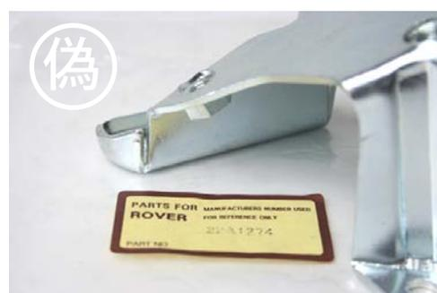
溶接されていない粗悪純正コピー品と偽装ラベル
